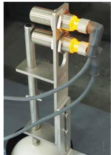
**3** Maschinenseitig werden ein Magnetventil zur Durchflusssteuerung (links) sowie ein berührungsloser Schwimmerschalter zur Pegelmessung (rechts) installiert (© Hanser)
