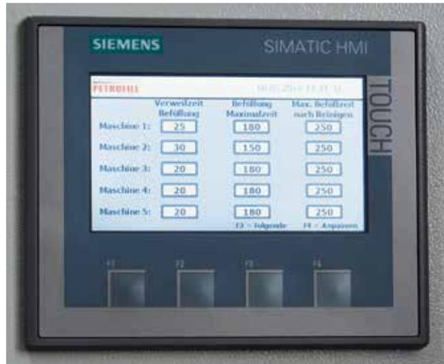
Maschinenseitig wird an den KSS-Tanks ein Schwimmerschalter mit Sensor installiert, der den gewünschten Pegelstand ständig überwacht. Volle Tanks bieten außerdem weniger Nährboden für einen bakteriellen Befall der Emulsion; die Standzeit verlängert sich. Ein Magnetventil regelt den programmierten KSS-Zufluss.
