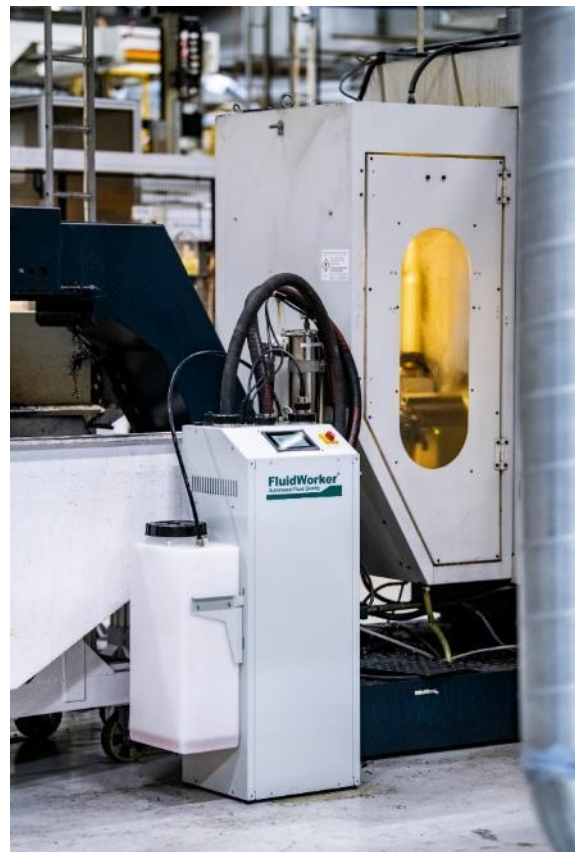
Abbildung 5: Der KSS Verbrauch hat sich aufgrund der stabilen und präzisen Konzentration drastisch reduziert
